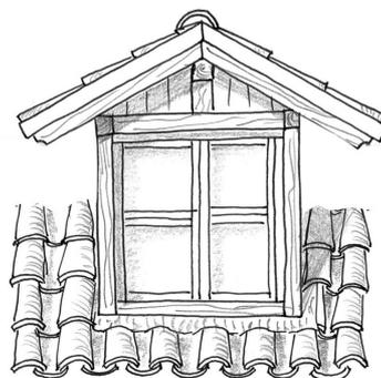
Larghezza di imposta delle spalle laterali massima di pari a due volte l'interasse fra i canteri fino ad un massimo di 1,6 m.
